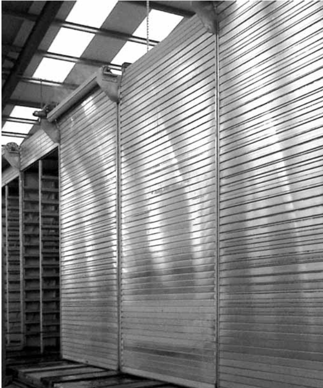
Die Ausführung der Härte-/Trockenkammern mit Rolltoren ist jederzeit möglich
