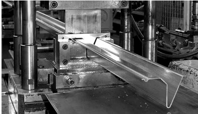
Vom Bandstahl-Coil zum fertigen Profil. Hochmoderne Fertigungsstraßen formen das HS-Spezialprofil – hier der Palettenträger der Snap-in-Verbindung
