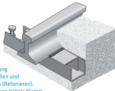
Schienenverlegung durch Anschweißen und späterer Verguss (Betonieren). Auch die Verlegung mittels Klemmplatten ist möglich.
