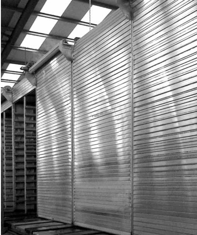
L'aggiunta di porte scorrevoli alle camere di tempra ed essiccazione è possibile in qualsiasi momento
